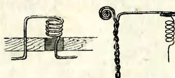
Рис. 9. Слева показано, как вставляется гнездо в доску; справа — детекторная стойка.
